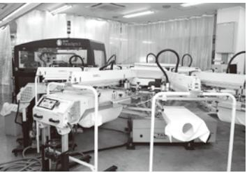
スクリーンプリント自動回転印刷機「TAS」とコード社のガーメントプリンター「パラダイムII」を組み合わせたスクリーンインクジェットプリント機。
