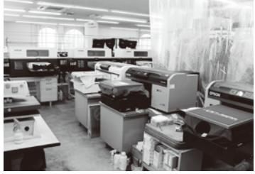
ガーメントプリンターは濃色ボディ用、淡色ボディ用で機種を分けて6台設備。フルカラープリントのウエアも小ロットから大量ロットまで対応できる。
