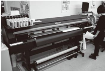
熱圧着に使用するプリント&カット機。その他にも帽子プリント機、タオルプリント専用台、マグカップ転写プレス機、缶バッジ製造機など様々な設備が揃っている。
