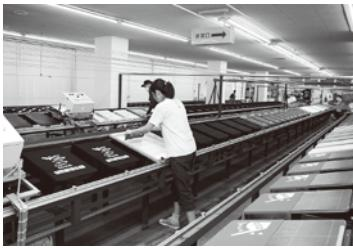
製品台は500面ある。濃色ボディには2回以上スキージングするのが同社のこだわり。袖への印刷には、専用の長台（60面）を使用する。
